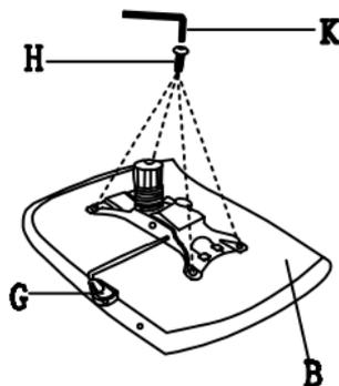
5 . Instale a base que já foi montada no assento já com o mecanismo de regulagem de altura fixado, de acordo com os passos anteriores.
