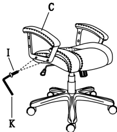
7 . Fixe o encosto (a) com o auxílio dos parafusos médios (i) e a chave hexagonal (K).
