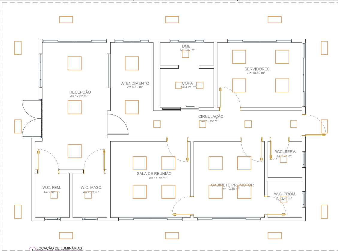
1 LOCAÇÃO DE LUMINÁRIAS ESCALA: 1:50
