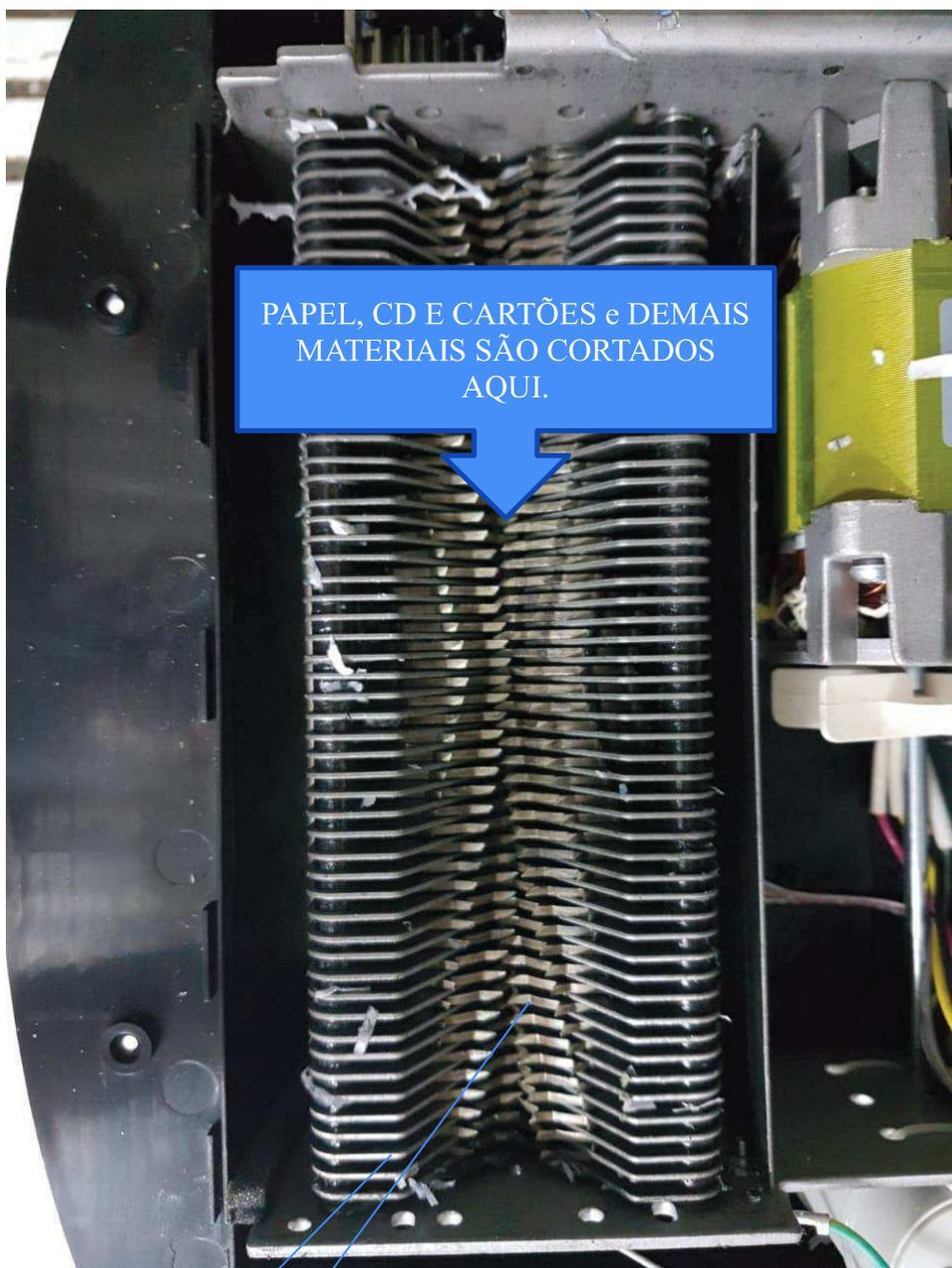
Estes são os pentes metálicos feito em aço, note que ficam entre as lâminas de corte e tem a função de expulsar o papel fragmentado.
